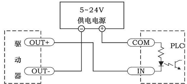
Y0接成sinking型输出，与PLC的输入相连
