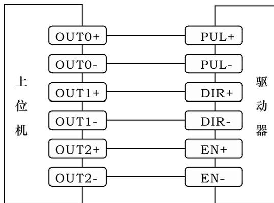
上位机的差分信号输出连接方式
