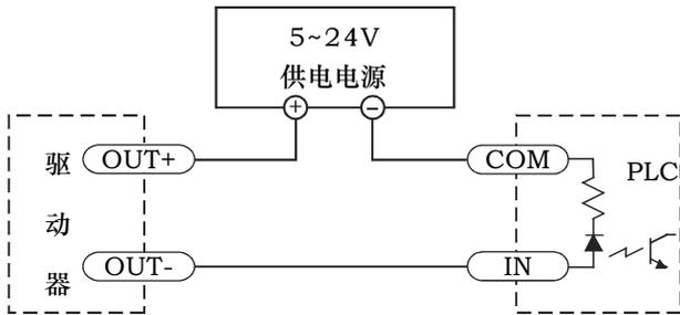
Y0接成sourcing型输出，与PLC的输入相连
