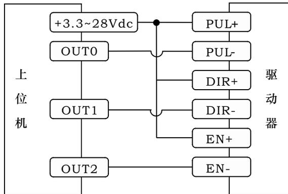
上位机的灌电流输出连接方式(共阳)
