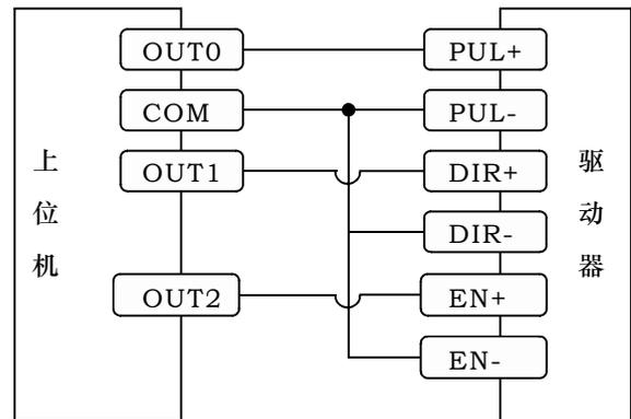
上位机的源电流输出连接方式(共阴)
